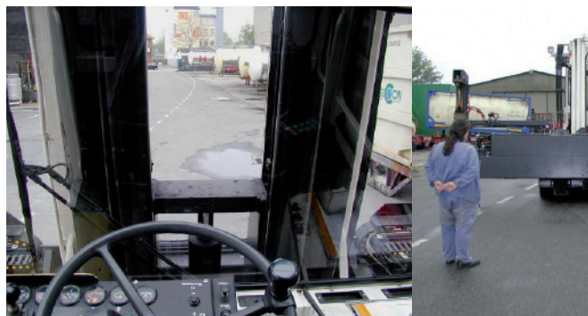
Преден изглед, възпрепятстван от прозоречната колона; позицията на водача не му позволява да види спътниците си.
