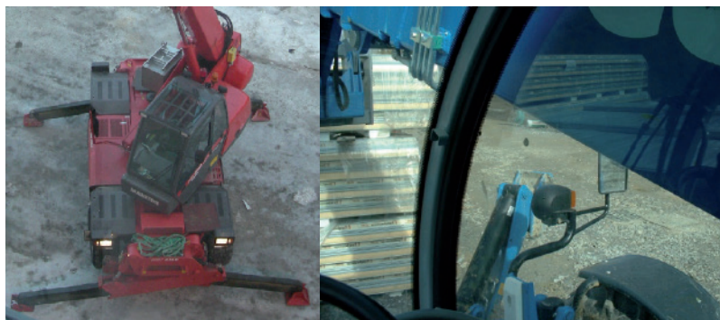
Machine à flèche latérale ; vision latérale bloquée par la flèche.
