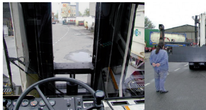
Vision frontale bloquée par le montant du pare-brise. L'opérateur est dans l'impossibilité de voir ses collègues.
