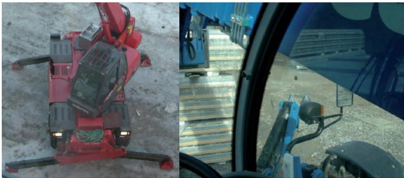
Máquinas con brazo lateral; visibilidad lateral obstruida.
