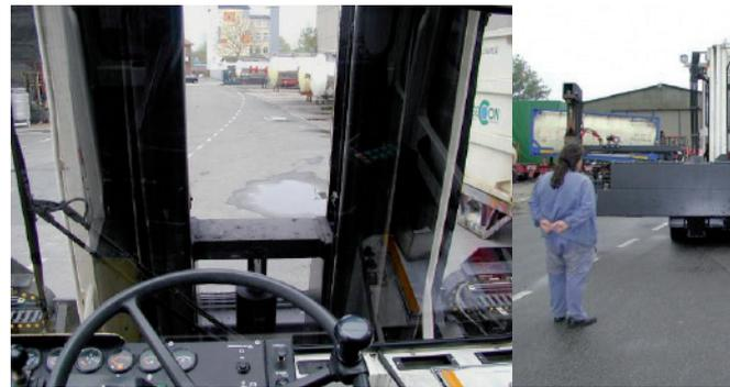
Visibilidad frontal obstruida por el montante del parabrisas; el conductor no puede ver a sus compañeros.
