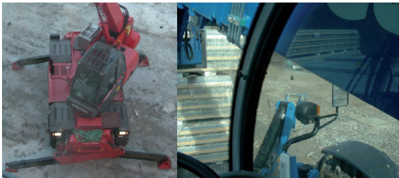
Maschinen mit Seitenausleger; der Ausleger behindert die seitliche Sicht.
