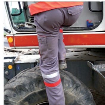
Der Maschinenbetreiber benutzt zum Absteigen instinktiv den Reifen statt des unergonomischen Zugangssystems.
