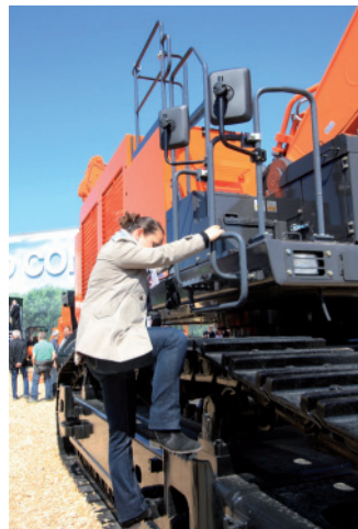
Unpraktischer Zugang für kleine Maschinenbediener.
