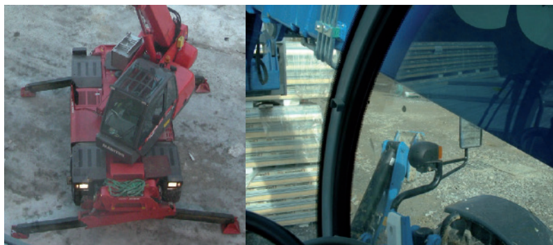
Urządzenia z bocznym wysięgnikiem; widok z boku zastonięty przez wysięgnik.
