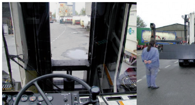
Widok z przodu zastonięty przez stółek nadwozia; kierowca pojazdu nie jest w stanie zobaczyć innych pracowników.
